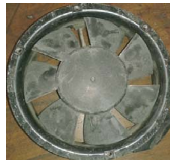
DC ventilation fan
